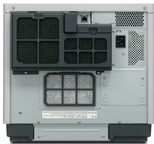
מאווררים מזרימים אוויר מסונן לתוך גוף המכשיר כדי לקרר אותו. קיים לחץ יתר קבוע כך שאבק לא יכול לחדור למכשיר.
