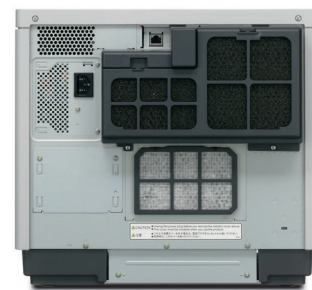
Ventilatoarele suflă aer filtrat în corpul aparatului, răcindu-l. Există o suprapresiune permanentă, astfel încât praful nu poate pătrunde în interior.
